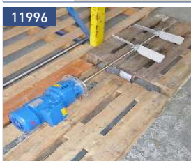
blades stirrer, 316 (1.4571) - unused - 0,75 kW - 123 rpm
