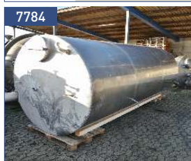
volume 12 cbm, 316 (1.4401) propeller: 0,55 kW
