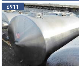
volume 11,5 cbm, 304 insulation 1,1 kW - 480 rpm
