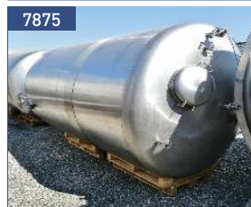
volume 12,2 cbm, 304 lateral agitator flange
