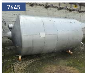
volume 8,6 cbm, 304 agitator: 1,2/2,2 kW - 14/30 rpm
