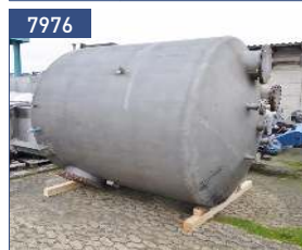
volume 12,5 cbm, 316 (1.4571) wt.: 5,2/5,3/5,7 mm no outlet in the lower bottom
