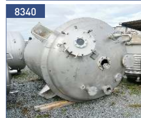
volume 12,5 cbm, 316 (1.4571) wt.: 3,8/4,0/4,8 mm blades stirrer 58 - 200 rpm
