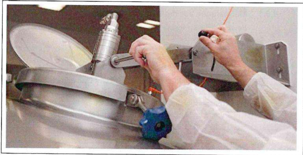
Abbildung 16 Reinigungsansatz auf dem Behälter
