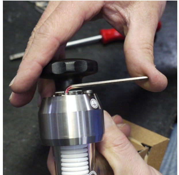
Bild 10: Gleichmäßiges Anziehen der Schrauben, jeweils eine halbe Umdrehung, bis deutlicher Widerstand spürbar ist.
