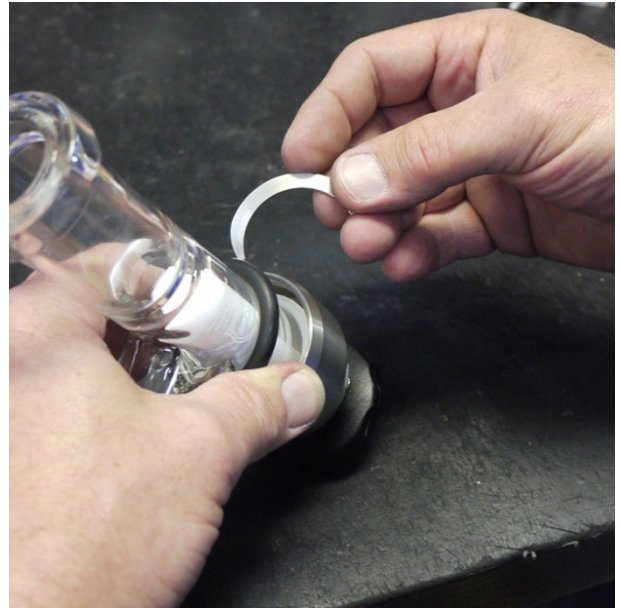
Bild 6: Einlegen der zweiteiligen Beilage mit der Schräge zur Glasschulter (Richtung Handrad).
