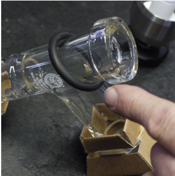
Bild 5: O-Ring so weit wie möglich zurückschieben.
