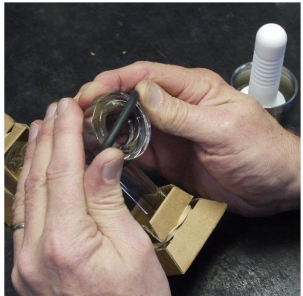
Bild 4: Vorbereitung des Gehäuses durch Überziehen des EPDM-Ringes.
