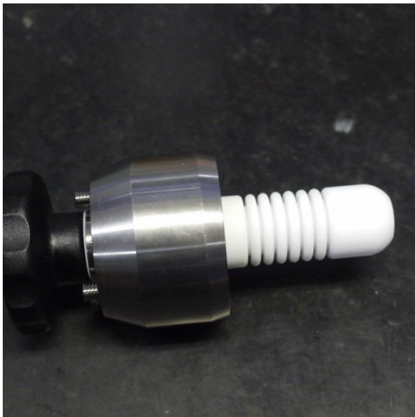
Bild 3: Aufschauben des neuen Faltenbalges bei herausgedrehter Spindel und Erdungsschraube. Danach Handrad nach der Faltenbalgmontage nach links zurückdrehen.
