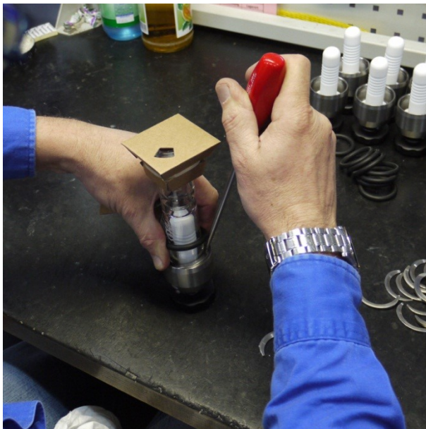
Bild 7: Ausrichten der ersten Beilage unter den Stützen und Einlegen der zweiten Beilage.
