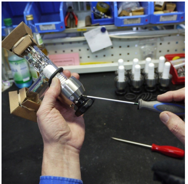
Bild 8: Schrauben leicht anziehen, dass Kopf noch bewegt werden kann
